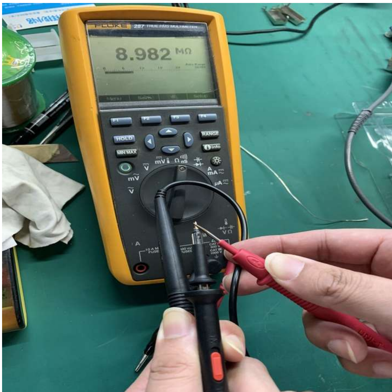
万用表测量探头X10档两端电阻
