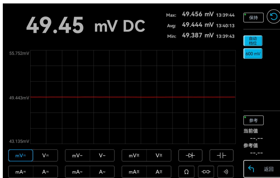
图 8-6 直流电压测量 mV
