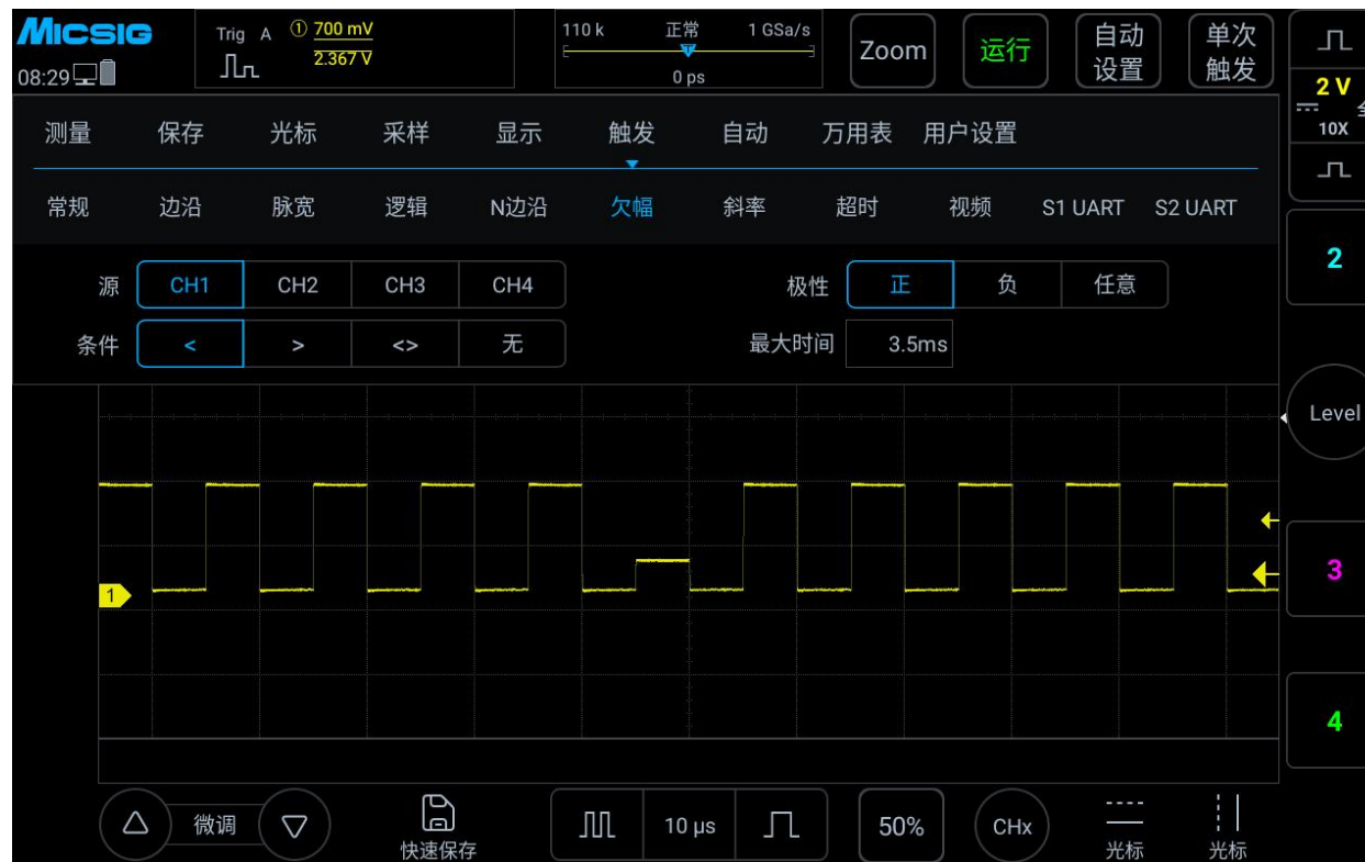
图 6-25 欠幅触发设置菜单
