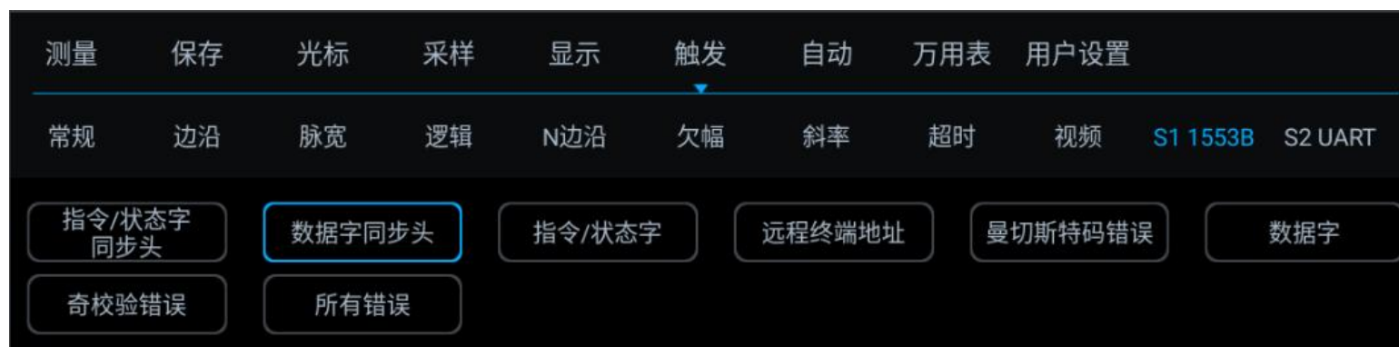
图 13-31 1553B 触发方式配置菜单
