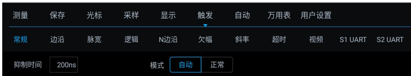
图 6-5 示波器触发模式设置
