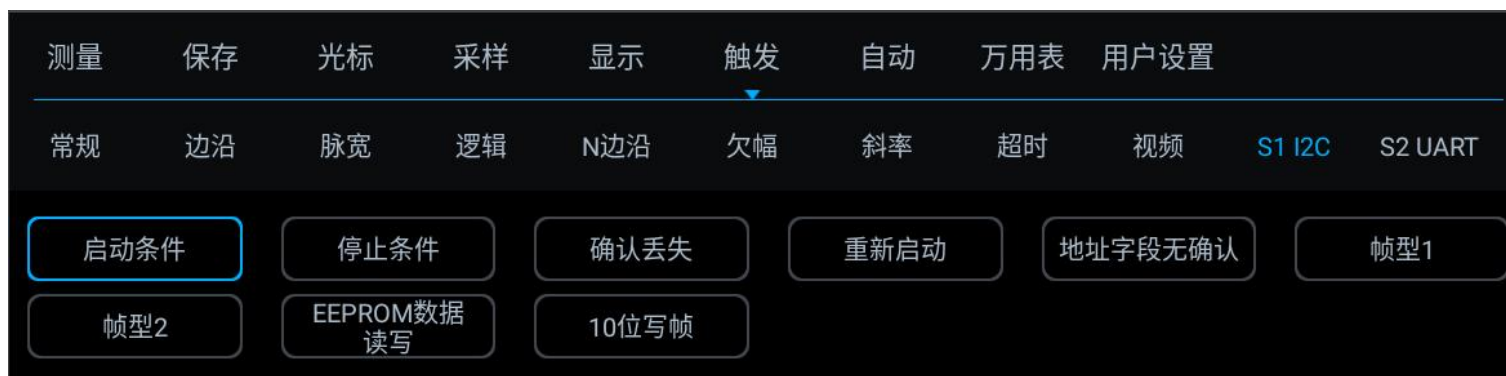
图 13-23 I2C 触发方式配置菜单
