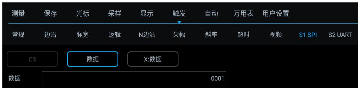
图 13-19 SPI 触发方式配置菜单
