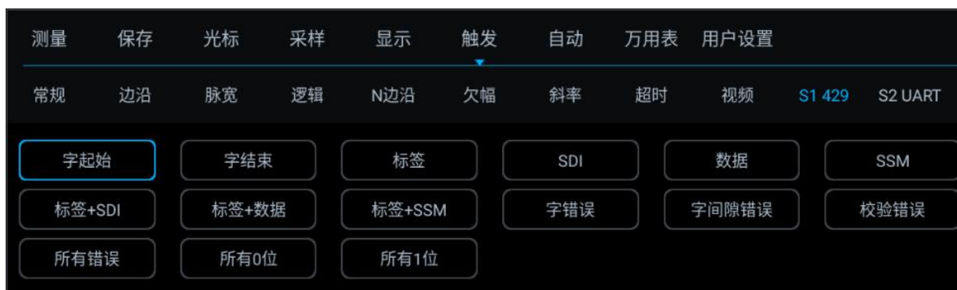
图 13-27 ARINC429 触发方式配置菜单
