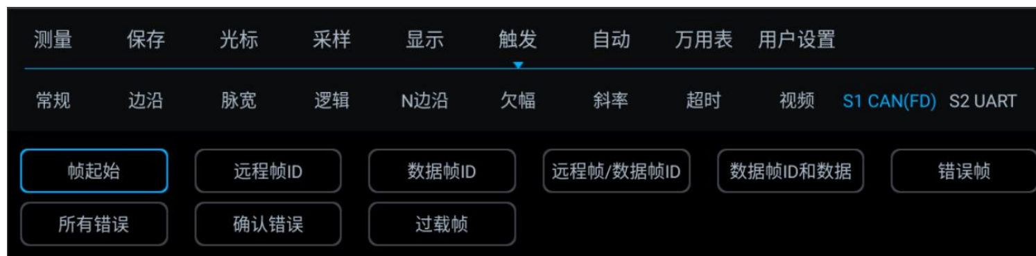
图 13-15 CAN 触发方式配置菜单
