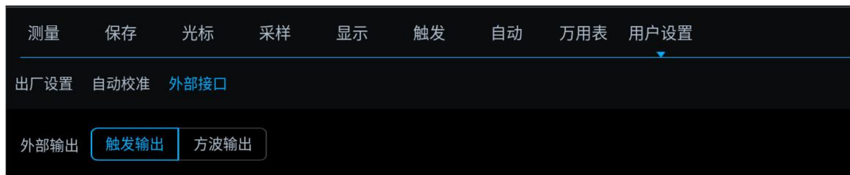
图 2-7 设置触发输出
