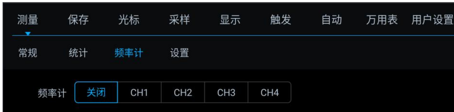
图 7-14 频率计测量菜单打开
